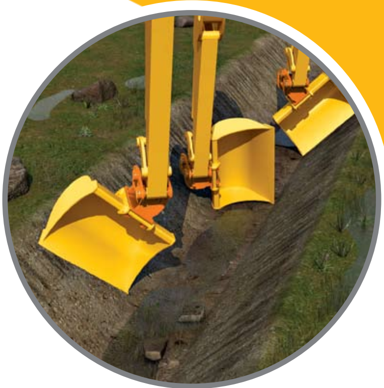
Räumen/Ausheben von Gräben
